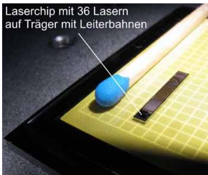
Abbildung 2: Foto eines VCSEL-Chips auf Siliziumträger, bereit für die Integration mit einem Fluidik-Chip
