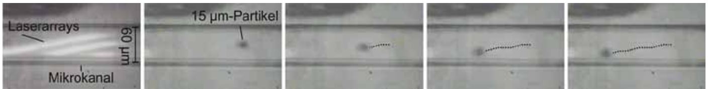
Abbildung 5: Ablenkexperiment mit einem Polystyrolpartikel mit 15 µm Durchmesser. Im linken Bild wurde der Infrarotfilter entfernt und die Laser werden nahe der Schwelle betrieben, um ihre Lage im Kanal sichtbar zu machen. Die Flüssigkeit durchströmt den Kanal von rechts nach links
