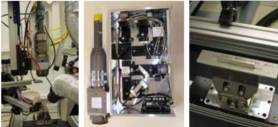
Abbildung 2: Links: Laseroptik mit Cross-Jet und Absaugung. Mitte: geöffnete MERlaS-Sensorik montiert an der Laseroptik. Rechts: Werkstück im Spannmittel. Die Schweißung erfolgt in die Stirnseite der Probe
