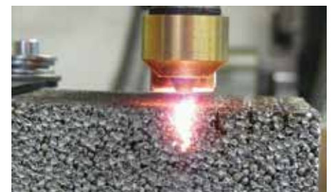
Abb. 2: Laserschneiden gesintertter Hohlkugelstruktur
