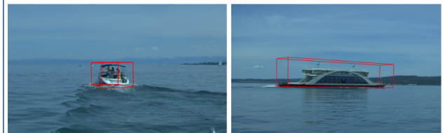
Lokalisierung der Objekte durch Bounding Box Vorhersage mit neuronalen Netzwerken.
