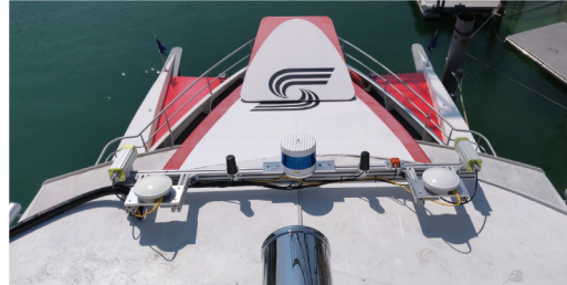
Katamaran Constanze , ausgestattet mit dem optischen Messaufbau.
