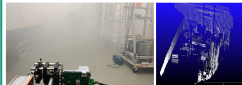
Abbildung 5: Links: LiDAR-Sensor in vernebeltem Raum. Rechts: Resultierende 3D-Punktwolke des Raumes mit vom Nebel verdeckten Objekten.
